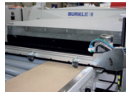
Querbürste zur Trägerplattenreinigung. Cross brush to clean the substrates
