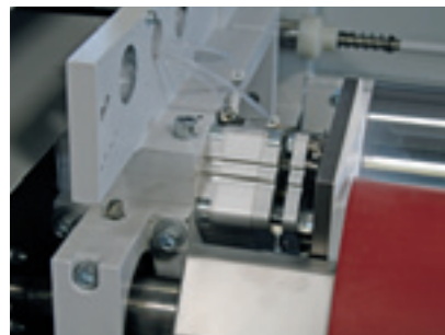
Pneumatisch angestellte Dichtbacken Pneumatically applied endplates
