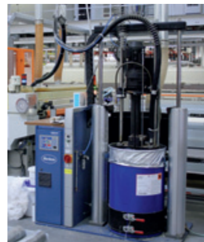
Fassschmelzer zum Aufschmelzen des Klebers Drum melting unit to melt the glue
