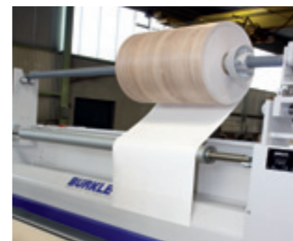
Abwickelstation über dem Kalanders Uncoiling station above the calender
