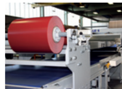
Abwickelstation mit Schneideeinrichtung. Uncoiling station with cutting device
