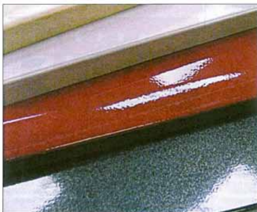
Hochglanzteile aus einer Membran-Presse. Deutlich erkennbare, nicht akzeptable Orangenhaut durch den Kontakt zur Membrane. Zu starke Beleimung sowie falsche Press-Parameter bei der Beschichtung sind die Ursache
